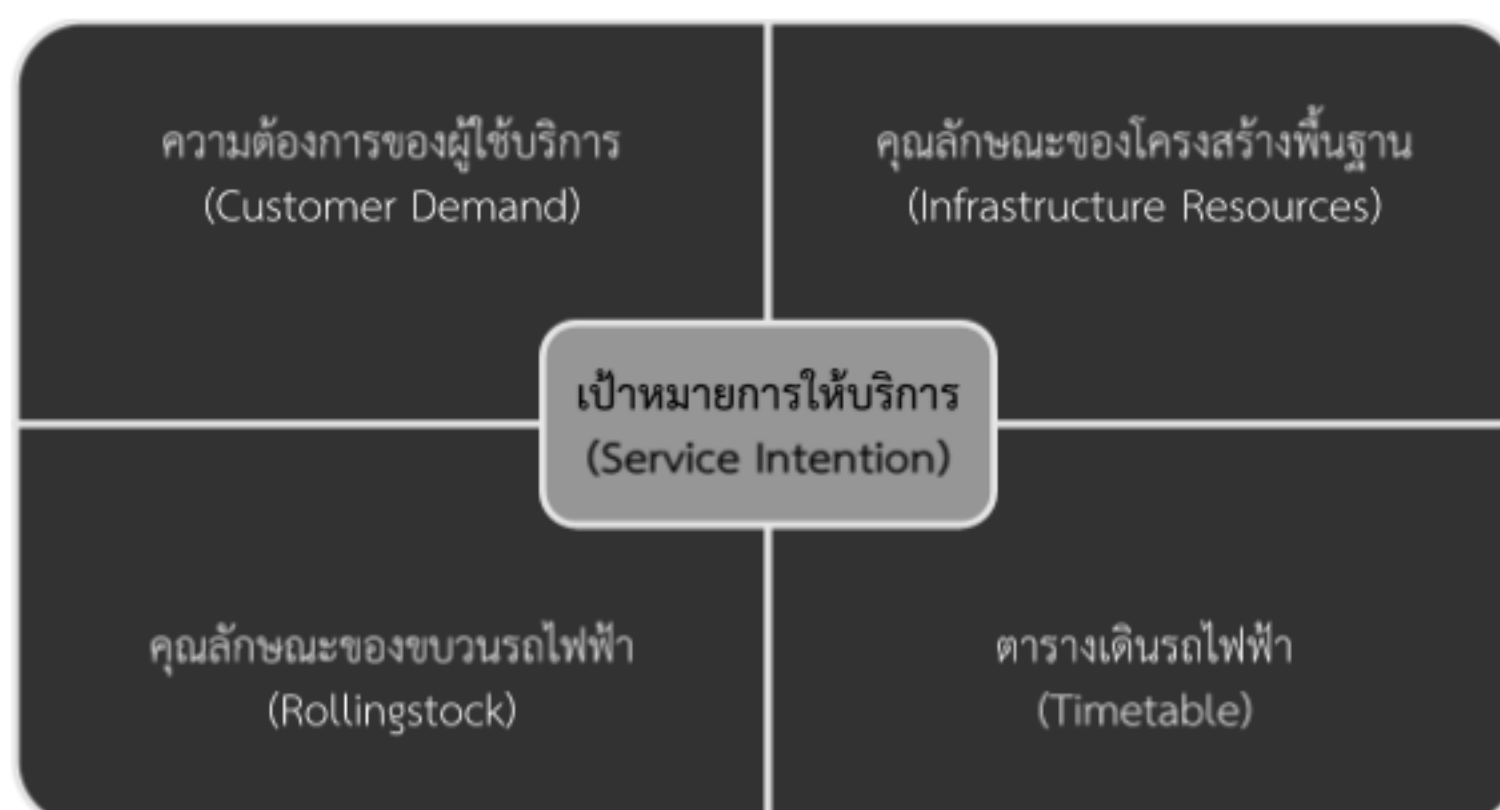
รูปที่ 2-1 องค์ประกอบหลักของระบบการจัดการเดินรถรถไฟฟ้าขนส่งมวลชน
