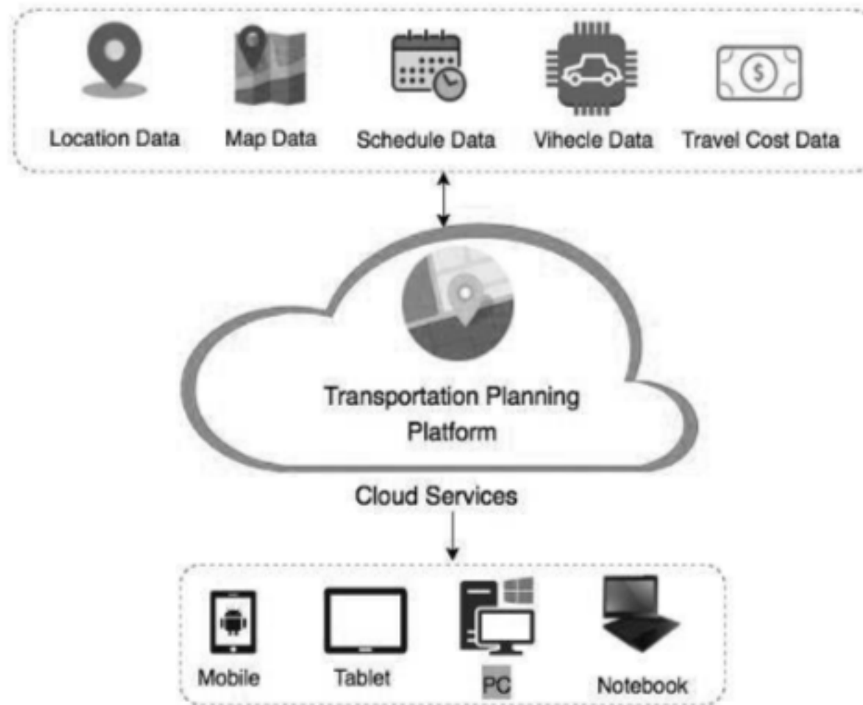
รูปที่ 4-3 แพลตฟอร์มกลางสำหรับการเชื่อมต่อบริการเดินรถ
